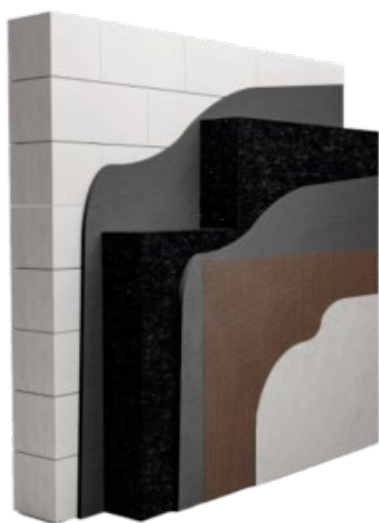
Tradycyjne ocieplenie: U = 0,20 \text{ W}/(\text{m}^2\text{K})
