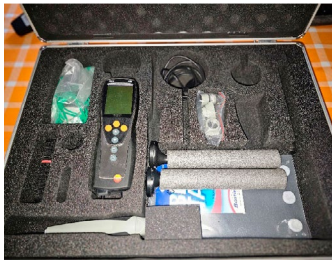
Fot. 2D. Widok urządzeń firmy TESTO z sondami model 635 w walizce transportowej oraz termometr do pomiarów powierzchni model T2, oraz termohigrometr model H2
