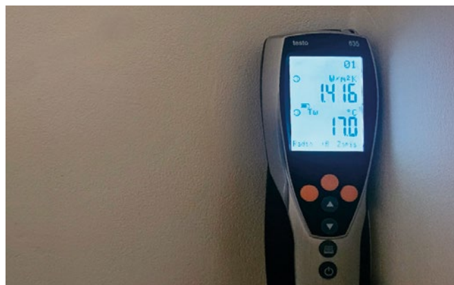
Fot. 7C. Widok powiększonego wyświetlacza z fot. 7B z odczytem współczynnika przenikania ciepła
