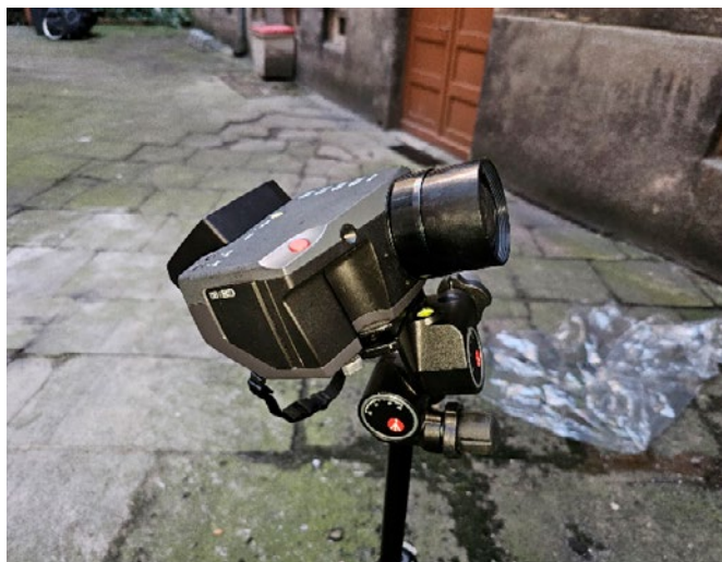
Fot. 2C. Widok wykorzystanej do pomiarów kamery termograficznej firmy VIGO system model V50 na statywie w trakcie pomiarów
