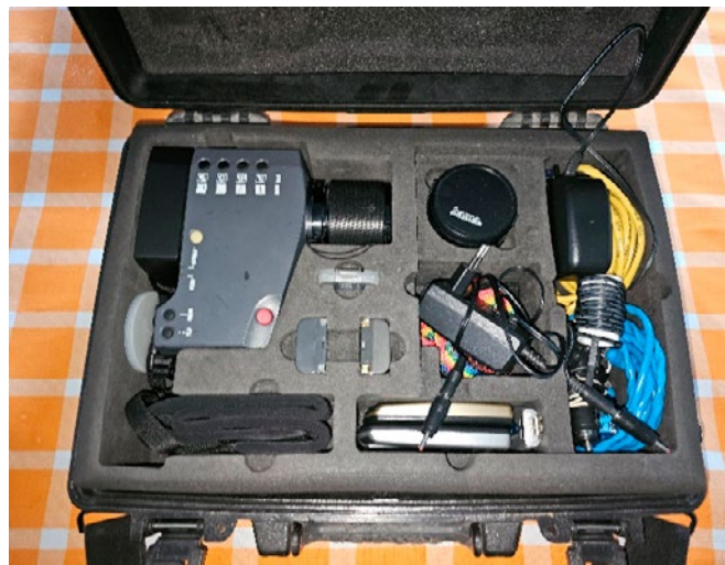
Fot. 2B. Widok wykorzystanej do pomiarów kamery termograficznej firmy VIGO system model V50 z walizką transportową
