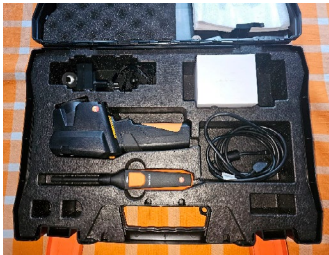
Fot. 2A. Widok wykorzystanej do pomiarów kamery termograficznej firmy TESTO model 832 z walizką transportową
