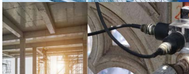
Dwa czujniki drgań zainstalowane prostopadle, aby monitorować drżania w płaszczyźnie
