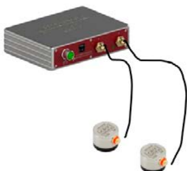
Analizator emisji akustycznej LinWave1002. Funkcjonalność IoT pozwala na przesyłanie danych pomiarowych do serwera z aplikacją Dashboard AE
