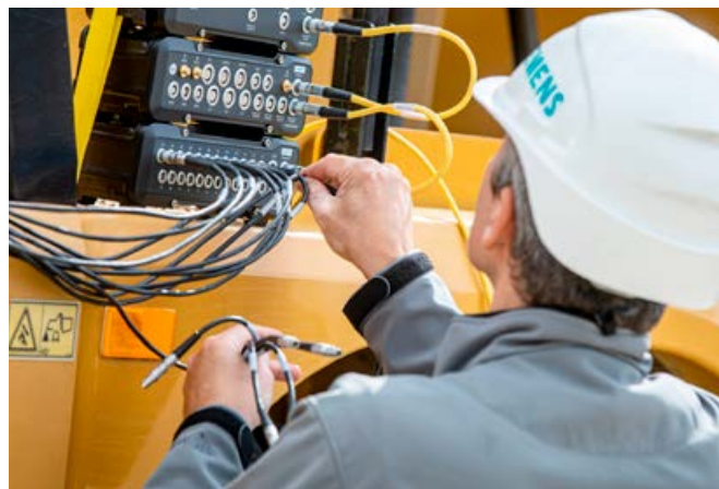
Wielokanałowy rejestrator Scadas RS ma konstrukcję modułową. Obsługuje: tensometry, akcelerometry, termopary oraz inne aktywne sensory
