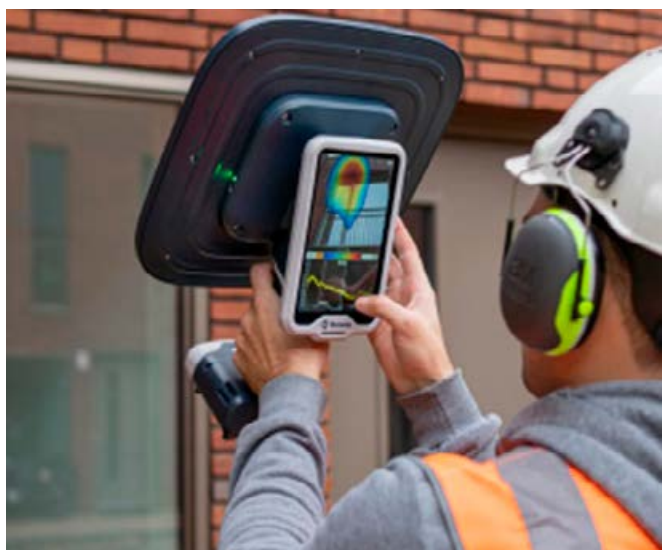
Kamera akustyczna Sorama CAM iV64 pomaga w lokalizowaniu przecieków akustycznych
