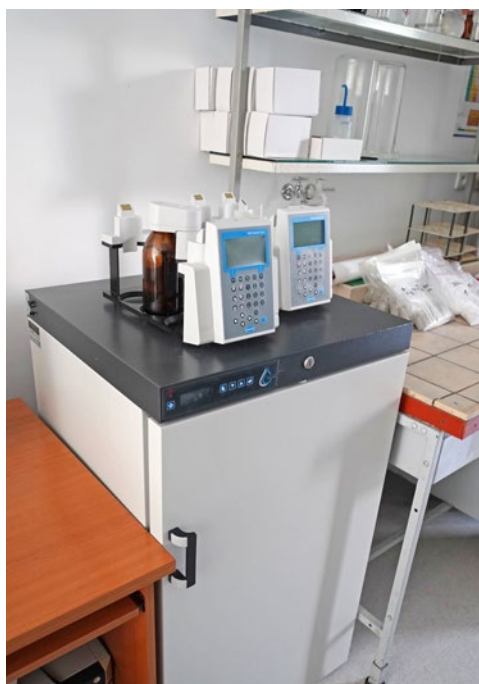
Fot. 1. Zestaw aparatury do oznaczenia biochemicznego zapotrzebowania tlenu (BZT) w wodzie i ściekach. a) widok ogólny, b) panel sterujący, c) badania w komorze utrzymującej stałą temperaturę 20°C
