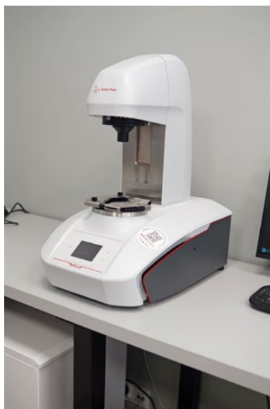
Fot. 3. Reometry rotacyjne Anton Paar MCR92 i MCR72 przeznaczone do badań reologicznych zaczynu i zapraw cementowych w warunkach kontrolowanej temperatury
