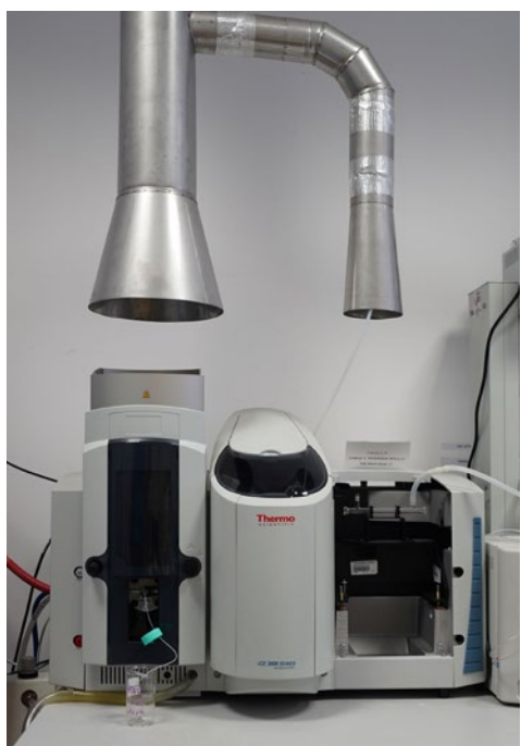
Fot. 2. Spektrometr absorpcji atomowej (AAS) wraz z przystawką do oznaczania rtęci techniką zimnych par. Oznaczanie zawartości metali w próbkach wód, ścieków, odpadów itp.
