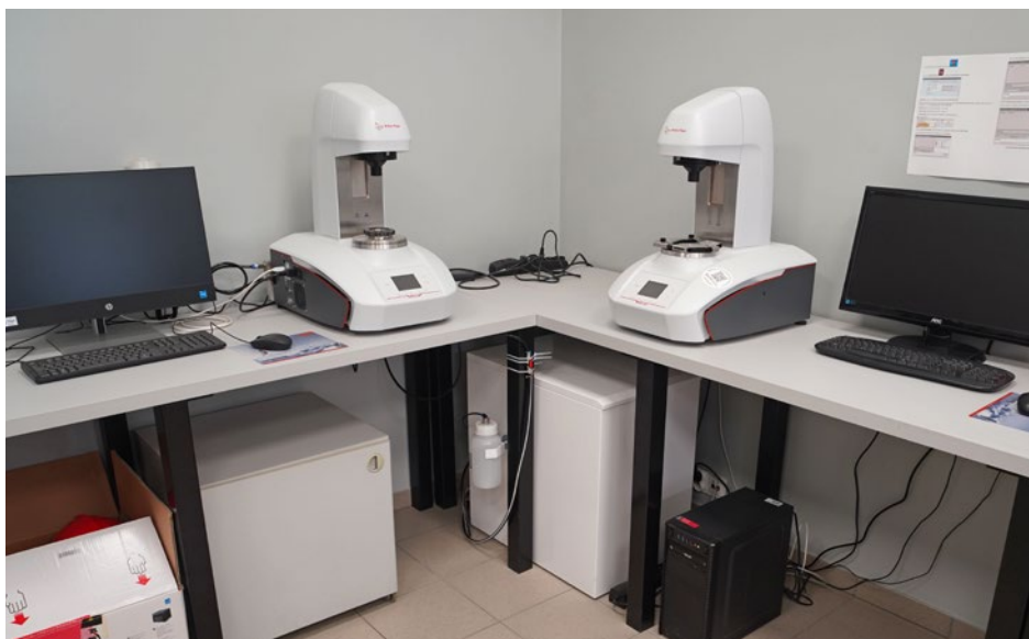
Fot. 3. Reometry rotacyjne Anton Paar MCR92 i MCR72 przeznaczone do badań reologicznych zaczynu i zapraw cementowych w warunkach kontrolowanej temperatury
