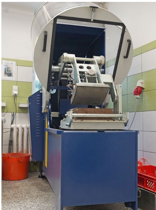
Fot. 6. Zagęszczarka walcowa do przygotowywania (zagęszczenia) mieszanek mineralno-asfaltowych
