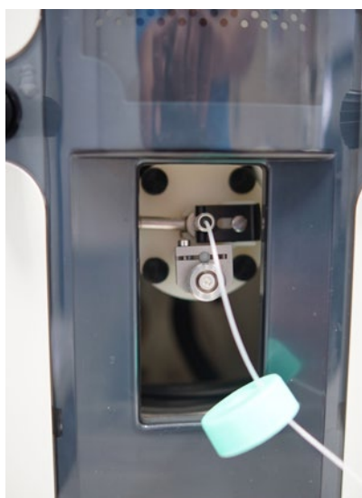
Fot. 2. Spektrometr absorpcji atomowej (AAS) wraz z przystawką do oznaczania rtęci techniką zimnych par. Oznaczanie zawartości metali w próbkach wód, ścieków, odpadów itp.
