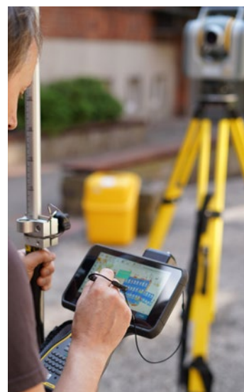
Fot. 9. Fototachimetr skanujący Trimble SX10. Urządzenie realizuje zadania z zakresu precyzyjnych pomiarów geodezyjnych, zapewniając najwyższe dokładności pomiaru kątów i odległości. Wykonuje skany 3D obiektów do chmury punktów, wspomagane dodatkowo zdjęciami fotogrametrycznymi
