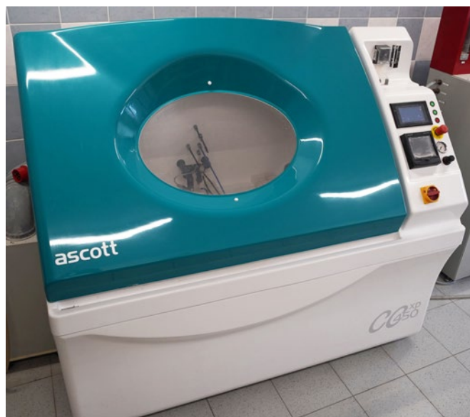
Fot. 7. Komora solna. Komora korozyjna umożliwia przeprowadzenie testów porównawczych. Materiały używane przez przemysł są narażone na korozję naturalną lub przemysłową w postaci mgły solnej, wilgotności i dymu. Dzięki komorze korozyjnej można przewidzieć odporność na korozję takich materiałów jak betony, zaprawy, cegły itp.
