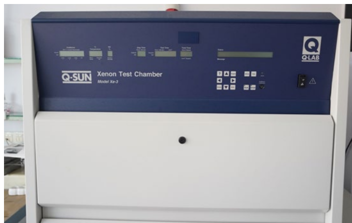
Fot. 4. Komora starzeniowa. Do badań procesów starzenia się materiałów. W ciągu kilku dni lub tygodni odtwarza uszkodzenia materiałów, które powstają w ciągu miesięcy lub lat w warunkach atmosferycznych z uwzględnieniem pełnego widma światła słonecznego, kwaśnych opadów itp. Do badań odporności na światło, trwałości koloru, fotostabilności itp.
