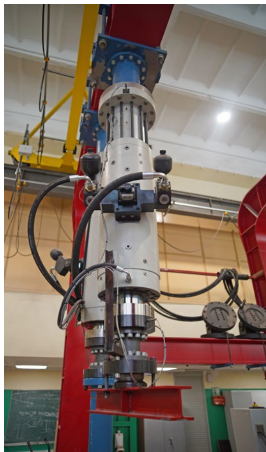
Fot. 8. Stanowisko do badań elementów konstrukcji budowlanych. Stanowisko składa się z dwóch ram o rozstawie słupów 4 m i wysokości 5 m oraz zestawu dwóch siłowników hydraulicznych firmy Zwick/Roell wywierających obciążenie do 500 kN każdy. Siłowniki umożliwiają realizację obciążeń zarówno w zakresie statycznym, jak i dynamicznym
