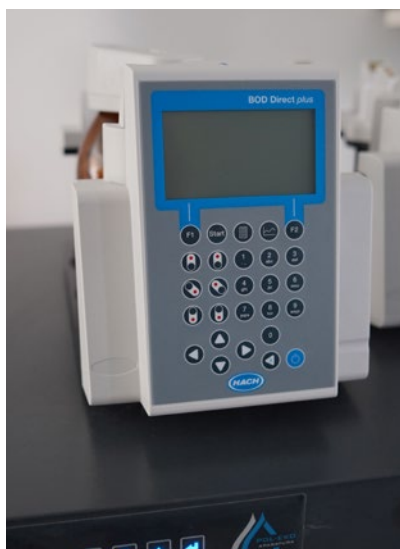
Fot. 1. Zestaw aparatury do oznaczenia biochemicznego zapotrzebowania tlenu (BZT) w wodzie i ściekach. a) widok ogólny, b) panel sterujący, c) badania w komorze utrzymującej stałą temperaturę 20°C
