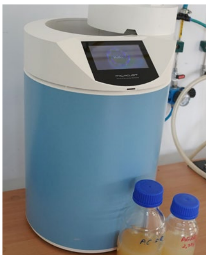
Fot. 5. Autoklaw mikrofalowy – do szybkiej dezynfekcji ciekłych substancji wykorzystywanych w badaniach mikrobiologicznych
