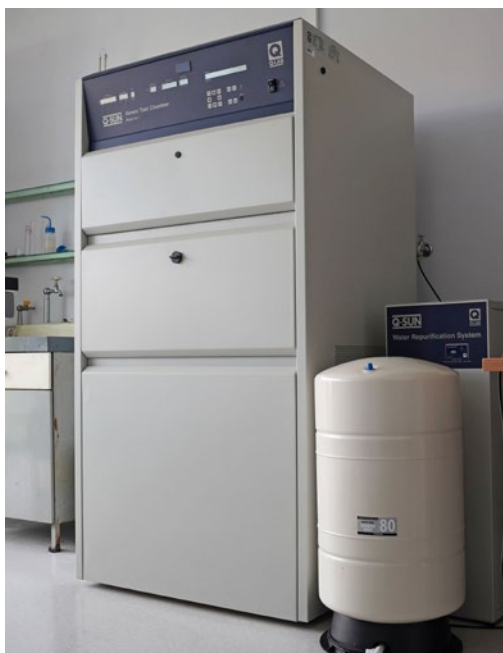
Fot. 4. Komora starzeniowa. Do badań procesów starzenia się materiałów. W ciągu kilku dni lub tygodni odtwarza uszkodzenia materiałów, które powstają w ciągu miesięcy lub lat w warunkach atmosferycznych z uwzględnieniem pełnego widma światła słonecznego, kwaśnych opadów itp. Do badań odporności na światło, trwałości koloru, fotostabilności itp.
