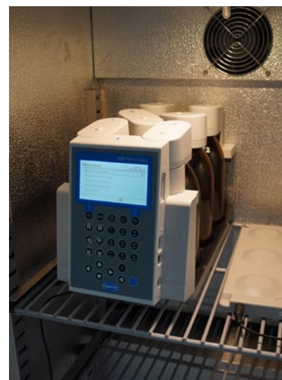
Fot. 1. Zestaw aparatury do oznaczenia biochemicznego zapotrzebowania tlenu (BZT) w wodzie i ściekach. a) widok ogólny, b) panel sterujący, c) badania w komorze utrzymującej stałą temperaturę 20°C
