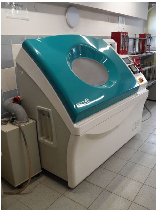
Fot. 7. Komora solna. Komora korozyjna umożliwia przeprowadzenie testów porównawczych. Materiały używane przez przemysł są narażone na korozję naturalną lub przemysłową w postaci mgły solnej, wilgotności i dymu. Dzięki komorze korozyjnej można przewidzieć odporność na korozję takich materiałów jak betony, zaprawy, cegły itp.
