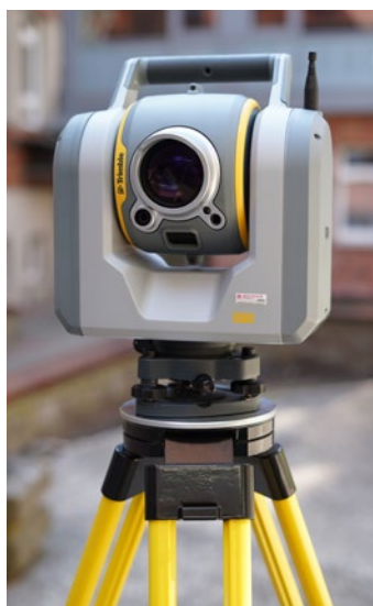
Fot. 9. Fototachimetr skanujący Trimble SX10. Urządzenie realizuje zadania z zakresu precyzyjnych pomiarów geodezyjnych, zapewniając najwyższe dokładności pomiaru kątów i odległości. Wykonuje skany 3D obiektów do chmury punktów, wspomagane dodatkowo zdjęciami fotogrametrycznymi
