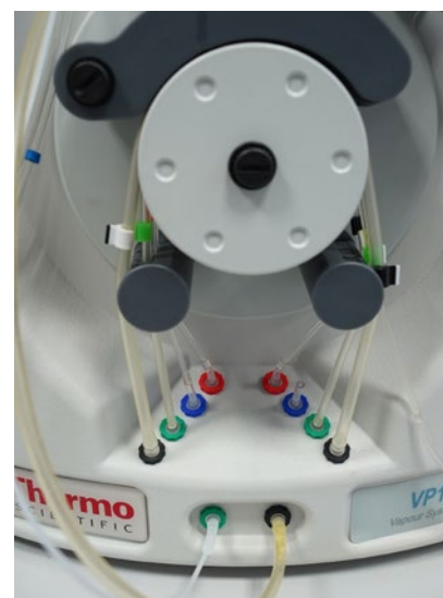
Fot. 2. Spektrometr absorpcji atomowej (AAS) wraz z przystawką do oznaczania rtęci techniką zimnych par. Oznaczanie zawartości metali w próbkach wód, ścieków, odpadów itp.
