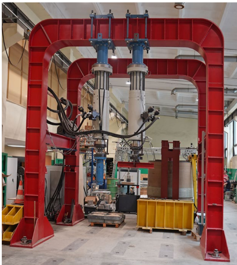
Fot. 8. Stanowisko do badań elementów konstrukcji budowlanych. Stanowisko składa się z dwóch ram o rozstawie słupów 4 m i wysokości 5 m oraz zestawu dwóch siłowników hydraulicznych firmy Zwick/Roell wywierających obciążenie do 500 kN każdy. Siłowniki umożliwiają realizację obciążeń zarówno w zakresie statycznym, jak i dynamicznym
