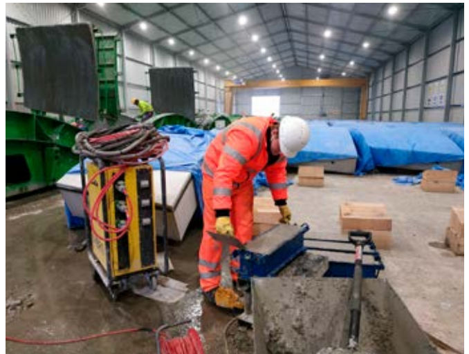
Fot. 6. Formowanie próbek przez laboratorium WT LD
